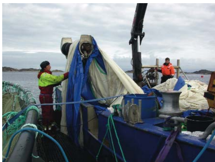
Presenningen kjøres ut med rekkemontert kraftblokk og den heves med hjelp av vinsjer og spesialutviklede oppdriftspølser.
