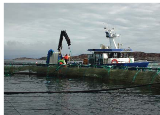
Klargjøring for avlusning. Selve prosedyren starter med at nota heises opp til omtrent fem meters dyp, samtidig som bunnringen løftes opp til seks meter
